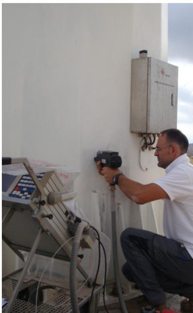
Figura 4a – Analisi spettrometrica in situ
