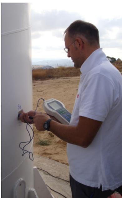
Figura 4b – Prova di durezza in situ
