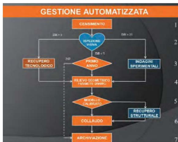
Fig.5 Schema di un approccio programmatico di ispezione
