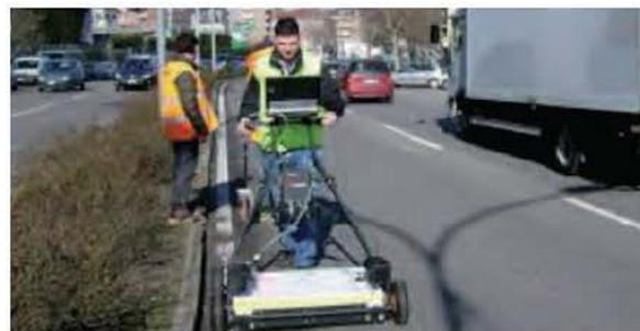
Figura 2 - Rilevamento degli impianti nel sottosuolo con la tecnica del Georadar
