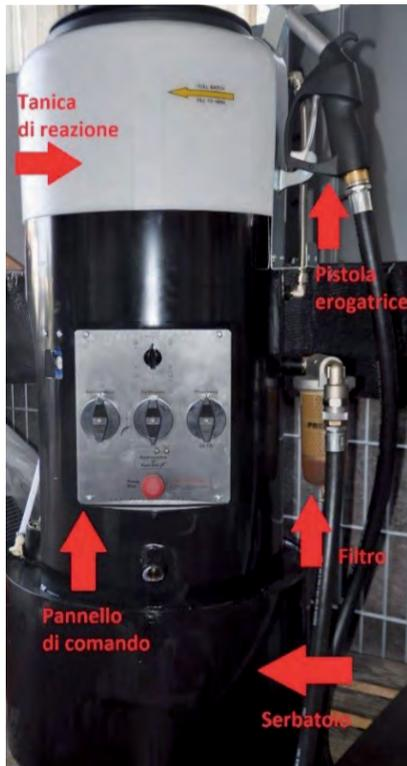
Fig.2 dispositivo per la transesterificazione degli oli dettaglio compo...
