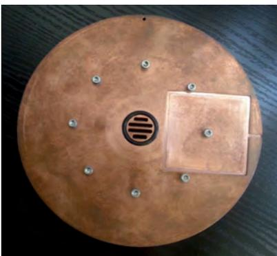
Fig. 3: Elettrodo con o-ring e fori centrali
