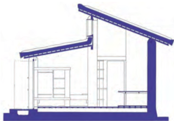
Figura 4 - Sezione delle Le Murondins di Le Corbusier
